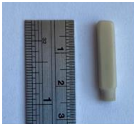
Рис. 65. Пробирка (заготовка) из твердого электролита на основе Gd_2Zr_2O_7 для O^{2-} -сенсора
