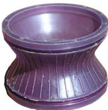
Рис. 50. Манжета газорегулятора из материала, полученного с использованием новых отвердителей.
